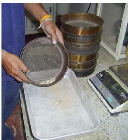
รูปที่ 1.3 แยกตัวอย่างที่ค้ำบนแต่ละตะแกรง รูปที่ 1.4 ชั่งน้ำหนักตัวอย่างที่ค้ำตะแกรงออกจากตะแกรง แต่ละขนาด
