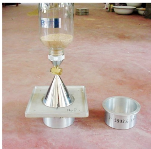
รูปที่ 1 การ Calibrated ทราย
