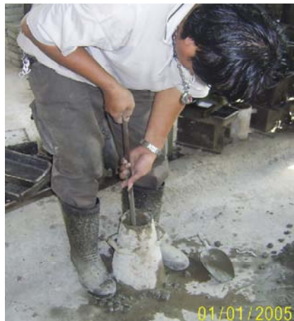
รูปที่ 3 กระทุ้งชั้นละ 3 ชั้นๆ 25 ครั้ง
