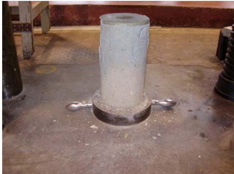
รูปที่ 7 แท่งตัวอย่างรูปทรงกระบอกที่กวดจนวิบัติ
