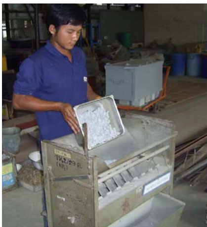
รูปที่ 1 สุ่มตัวอย่างด้วยเครื่องแบ่งตัวอย่างรูปที่ 2 เช็ดตัวอย่างที่แช่น้ำไว้ให้มีสภาพอิ่มตัวผิวแห้ง
