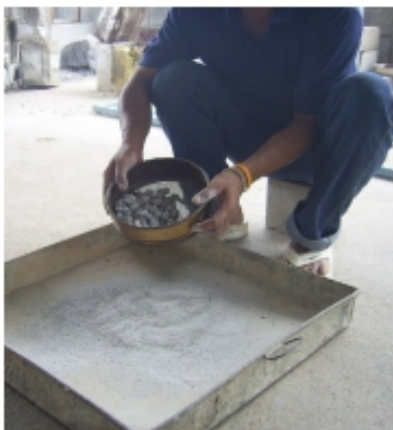
รูปที่ 5 ร่อนตัวอย่างด้วยตะแกรงเบอร์ 12 รูปที่ 6 ชั่งตัวอย่างที่ค้างตะแกรงเบอร์ 12 เพื่อหาน้ำหนักหลังการทดสอบ
