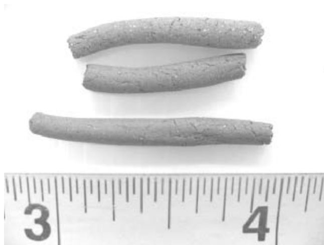
รูปที่ 3 ลักษณะรอยแตกบนผิวดินของเส้นตัวอย่าง
