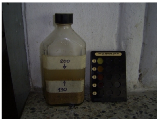
รูปที่ 2 เปรียบเทียบสีสารละลายกับกระจกสีมาตรฐาน
