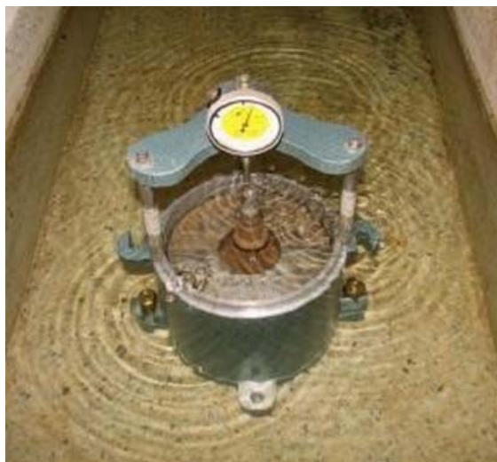
รูปที่ 2 วิธีวัดค่าการบวมตัวของตัวอย่าง ทดสอบแบบแช่น้ำ
