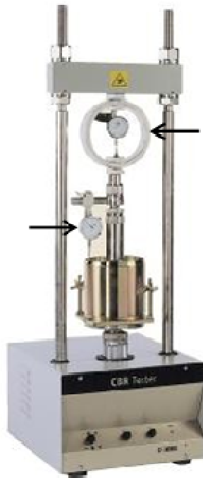
รูปที่ 4 การทดสอบแรงกดที่ระยะจมนต่างๆ ของแท่งกบดินตัวอย่างทดสอบ
