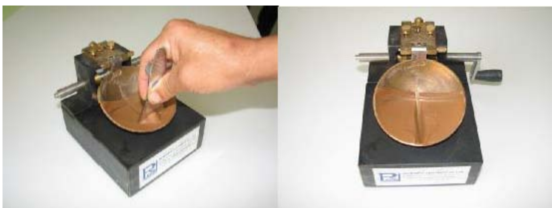
รูปที่ 2 การปาดตัวอย่างให้เป็นร่องตรงกลาง
