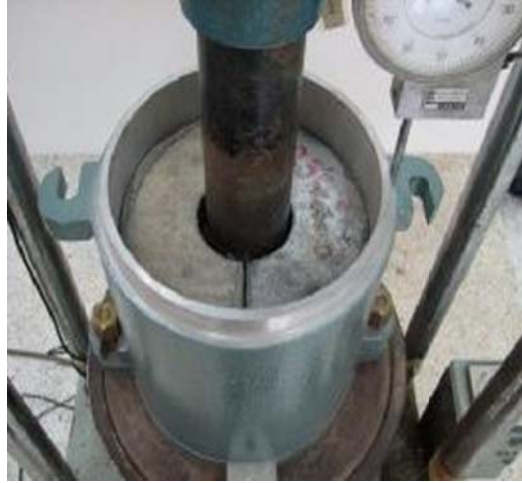
รูปที่ 3 การตั้งให้แท่งกดอยู่ตรงพอดีกับรูตรงกลางของน้ำหนักรีดทับ
