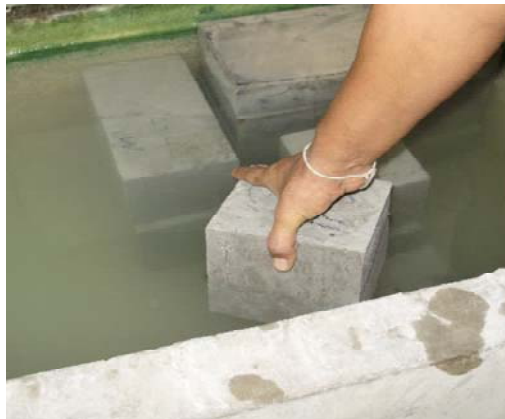
รูปที่ 3 การบ่มแท่งตัวอย่างด้วยน้ำ
