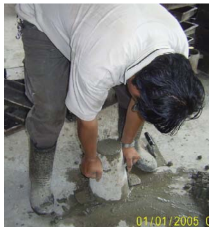
รูปที่ 5 ยกกรวยขึ้นตรงๆ ในแนวตั้ง
