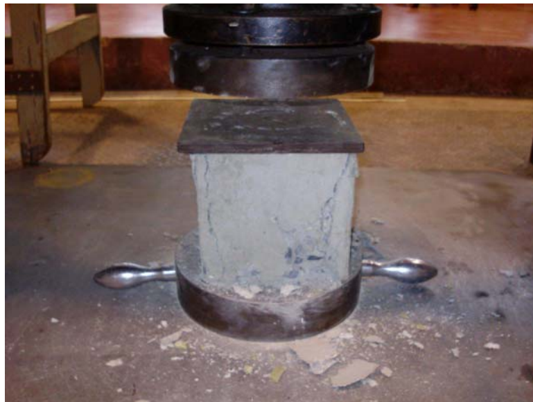
รูปที่ 6 แท่งตัวอย่างรูปทรงลูกบาศก์ที่กดจนวิบัติ
