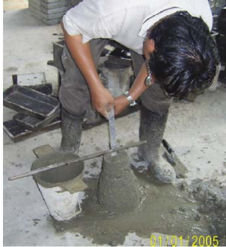
รูปที่ 6 วัดค่ายุบตัวพร้อมทั้งสังเกตลักษณะการทรุดตัว
