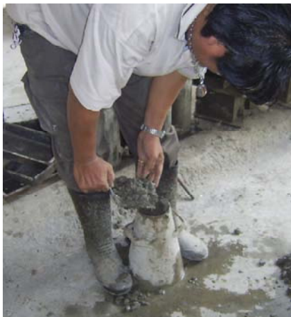
รูปที่ 2 ตักคอนกรีตใส่กรวย \frac{1}{3} ของปริมาตร
