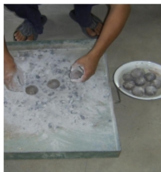
รูปที่ 4 แยกตัวอย่างออกจากลูกเหล็ก
