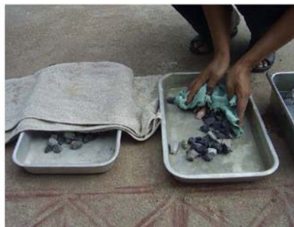
รูปที่ 1 สุ่มตัวอย่างด้วยเครื่องแบ่งตัวอย่างรูปที่ 2 เช็ดตัวอย่างที่แช่น้ำไว้ให้มีสภาพอิ่มตัวผิวแห้ง
