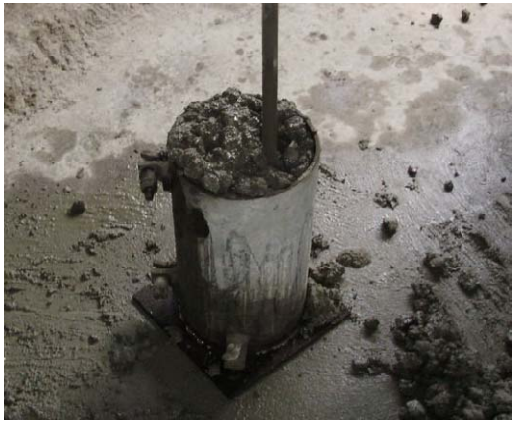
รูปที่ 1 การหล่อแท่งคอนกรีตโดยใช้เหล็กกระทุ้ง
