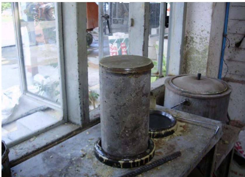
รูปที่ 3 การเคลือบผิวหน้าแท่งตัวอย่างรูปทรงกระบอกด้วยกัมมะถันหลอมเหลว
