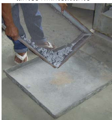
รูปที่ 2.3 แยกตัวอย่างที่ค้ำแต่ละตะแกรง รูปที่ 2.4 ชั่งน้ำหนักตัวอย่างที่ค้ำตะแกรงแต่ละขนาด ออกจากตะแกรง
