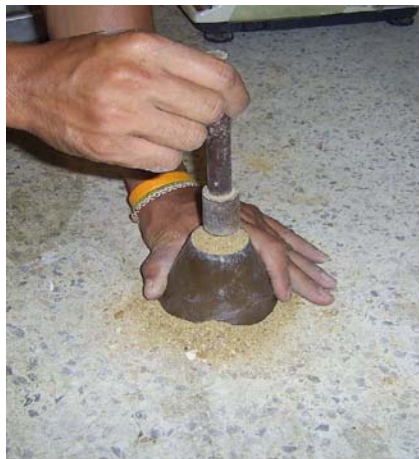
รูปที่ 4 ใช้แท่งตำโลหะตกระทบตัวอย่าง
