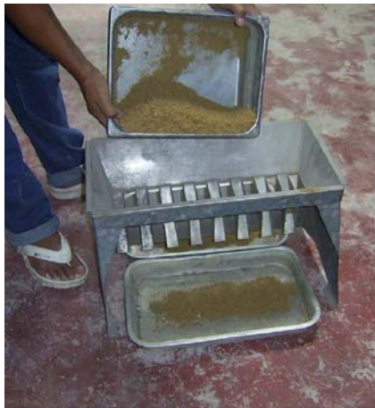
รูปที่ 2 แบ่งตัวอย่างทรายด้วยเครื่องแบ่งตัวอย่าง
