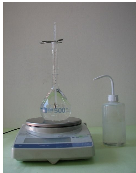
รูปผนวกที่ 2 วัดอุณหภูมิของน้ำ
