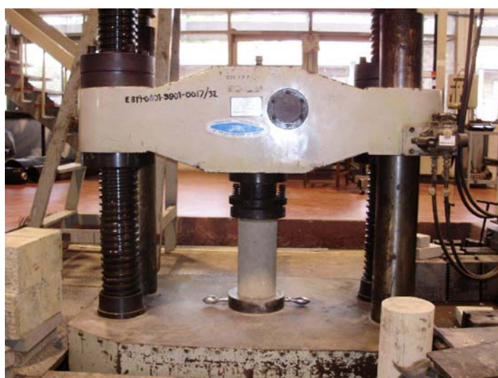
รูปที่ 4 การนำแท่งตัวอย่างบนกึ่งกลางของแท่นทดสอบ
