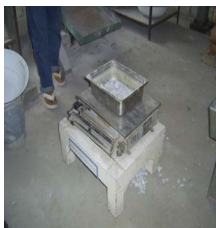
รูปที่ 2.3 แยกตัวอย่างที่ค้ำแต่ละตะแกรง รูปที่ 2.4 ชั่งน้ำหนักตัวอย่างที่ค้ำตะแกรงแต่ละขนาด ออกจากตะแกรง
