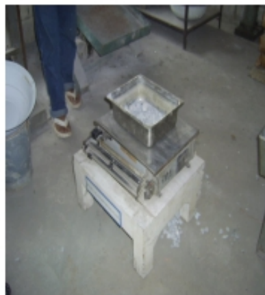
รูปที่ 5 ร่อนตัวอย่างด้วยตะแกรงเบอร์ 12 รูปที่ 6 ชั่งตัวอย่างที่ค้างตะแกรงเบอร์ 12 เพื่อหาน้ำหนักหลังการทดสอบ
