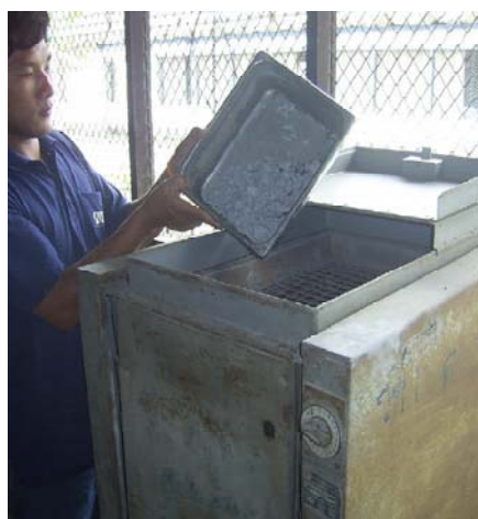
รูป 2.1 ติดตั้งตะแกรงกับเครื่อง ใส่ตัวอย่างที่เตรียมไว้ลงไป
