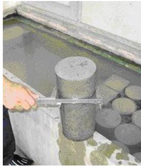
รูปที่ 2 วัดขนาดแท่งตัวอย่างรูปทรง กระบอก
