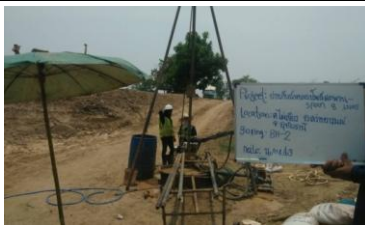
งานเจาะทดสอบดินฐานรากสะพานรถยนต์
