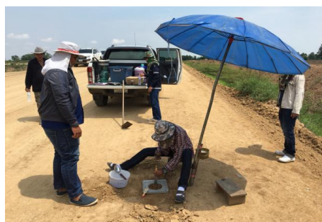
ทดสอบความแน่นชั้นวัสดุคัดเลือก ข งานถนนทดแทน
